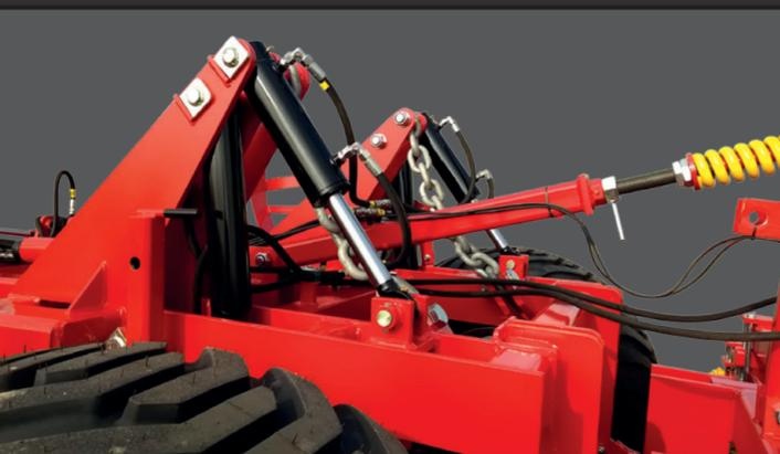
Hydraulische Tiefenregulierung über die Nachlaufwalze [Rohrpackerwalze Ø 600 oder DUO-Nockenwalze (siehe Abbildung rechts)].
