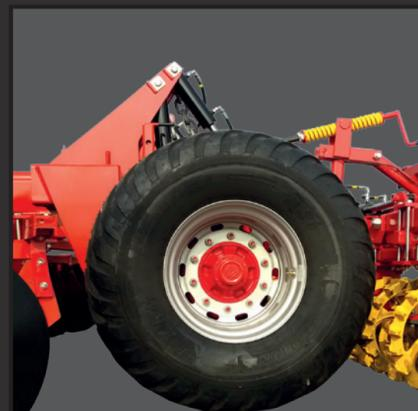
Die große Bereifung 550/60-22.5 sorgt für einen sicheren Transport.
