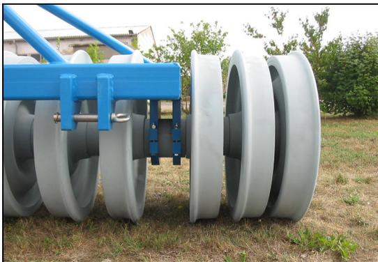
stabile Gleitlagerung für die 180mm massive Welle.
